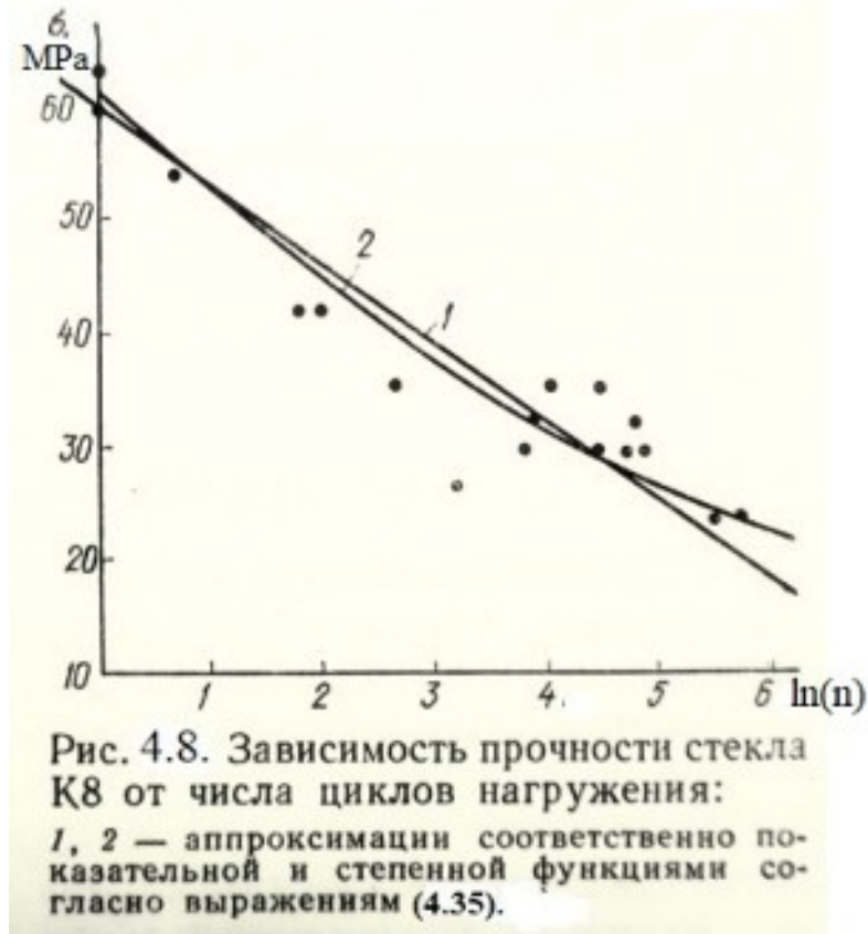
Рисунок 4.8. Зависимость прочности стекла от числа n циклов нагружения: 1, 2 – приближения соответственно показательной и степенной функциями по формулам (4.35).
