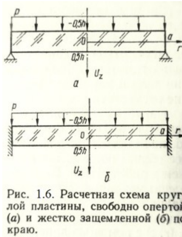
Рисунок 1.6. Расчётная схема круглой пластины, свободно опёртой (а) или жёстко защемлённой (б) по краю.
